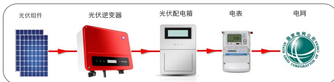
公司的光伏并网逆变器均为组串式逆变器，具有转化效率高、性能安全可靠等特点，可满足户内、户外等不同的应用环境要求，广泛应用于住宅、商业屋顶、农场、地面电站等光伏发电系统。公司产品种类齐全，组串式光伏并网逆变器涵盖 0.7kW~250kW 功率范围，全面满足各种类型光伏组件和电网并网要求，稳定高效运行于高温、高海拔、风沙、盐雾、低温等各种自然环境。
