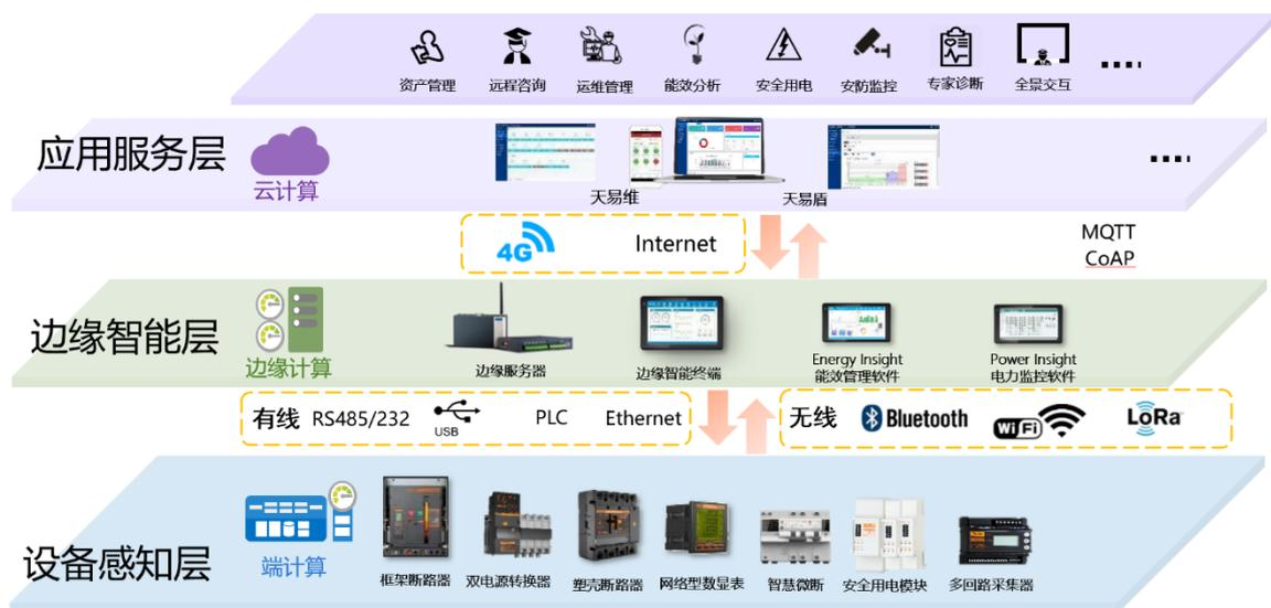
公司天正天智“TenEdge”智能配电系统基于物联网架构，依托智能断路器、模块等内置传感器，可采集各类电量参数，通过有线和无线网络将数据传送到本地软件显示和控制，同时可以将大数据存储在云端，提供能耗分析，安全用电，故障预警等专业化应用服务。
