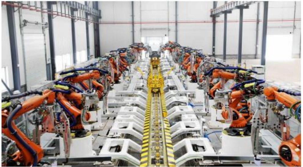
图：公司建造的地板焊装生产线
