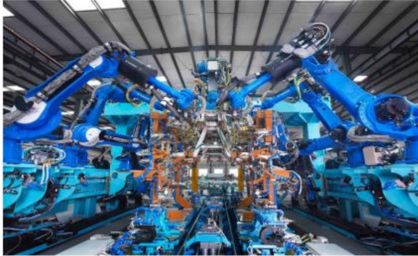
图：公司建造的总拼焊装生产线（局部）
