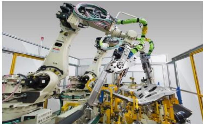
图：公司建造的门盖焊装生产线
