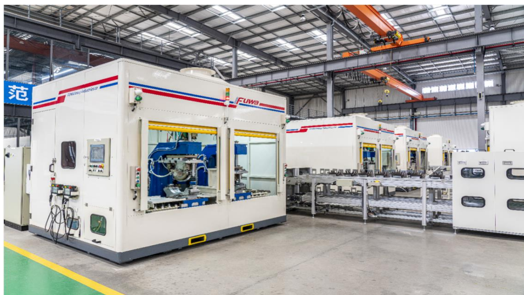
图：公司建造的机器人焊接工作站
