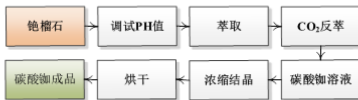
（铷盐的主要产品制备工艺流程图）
