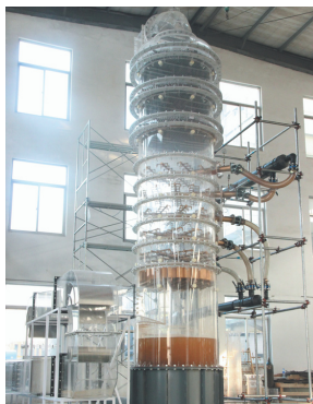
湿法脱硫流场物模实验平台
