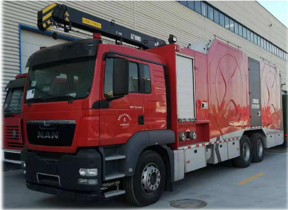
泵浦消防车（远程供水车）
