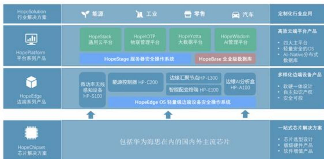
“4横”是指：从底层技术到上层应用的全栈技术能力和相关产品，包括一站式芯片解决方案、软硬一体的多样化边缘、终端设备产品、高效云端平台产品、定制化的行业应用方案。
