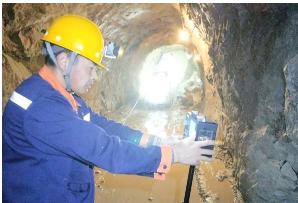
苏尼特金矿公司对井下粉尘进行检测
