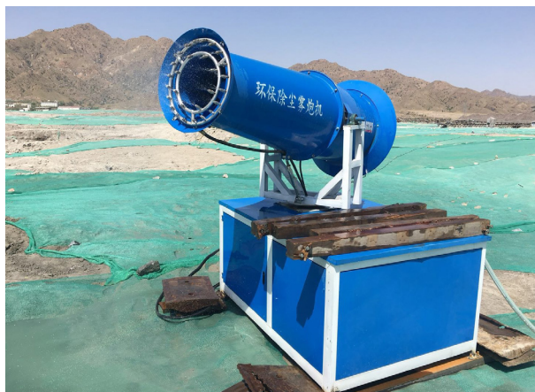
包头鑫达公司环保除尘雾炮机
