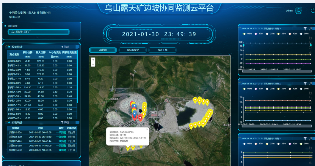
乌山露天矿边坡协同监测云平台主界面
