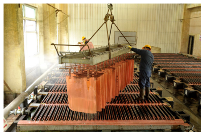
潼关冶炼公司电铜车间利用危废生产电解铜
