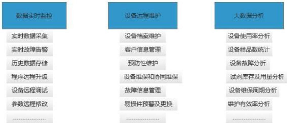
系统将采集的数据在云服务器上进行大数据的存储，并通过云服务端的预处理程序和算法对采集的数据进行有效分析，实时性地对设备的易损件更换、试剂存量、试剂串货使用、故障率异常、维护异常等进行预警，并实时将预警信息推送至相关管理人员的手机APP上，以有效的提高设备运维力度，降低运维成本。
