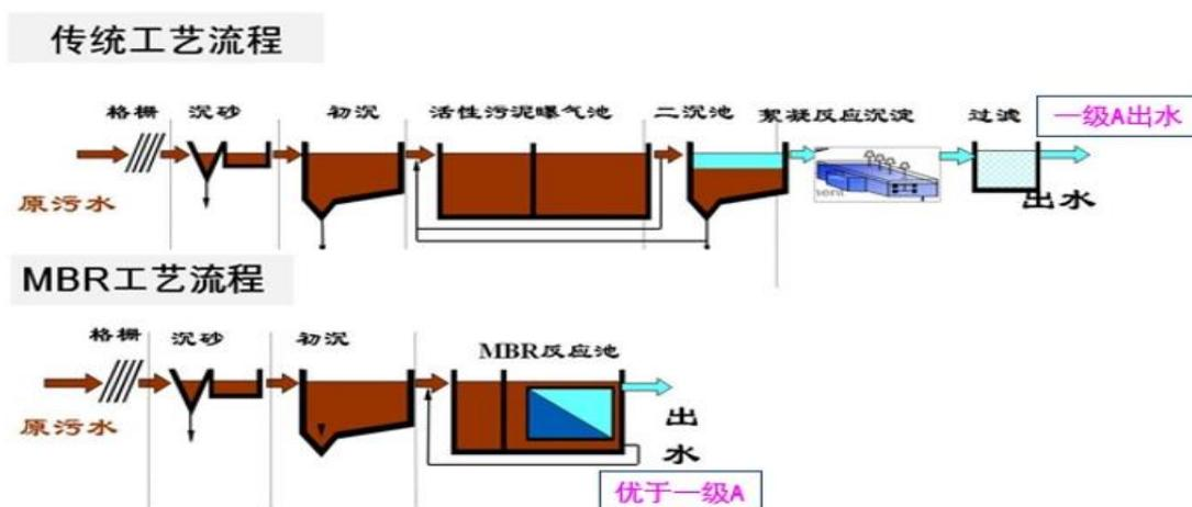
如上图，MBR 技术在污水处理工艺中的实际应用，即将膜分离装置直接置于生化池中，构成膜分离技术与生物处理技术有机结合的新型污水处理系统。而
