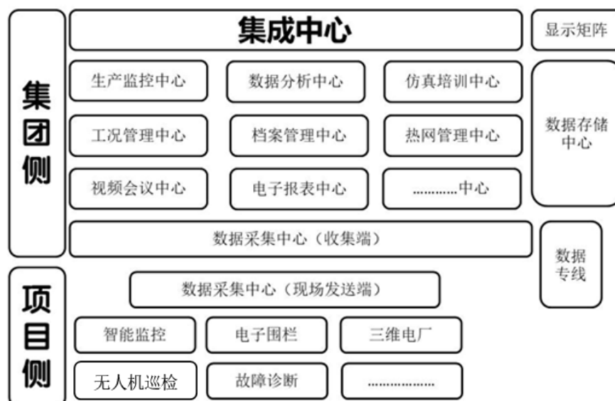
杭州热电集团信息中心结构分层图
