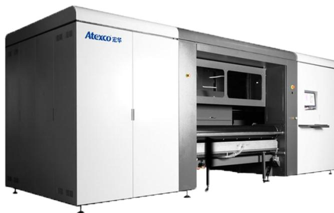
该款设备采用扫描式喷印，装载高精度工业级喷头，拥有可变墨点功能，最高喷印速度达 1,000 平方米/小时以上，典型喷印精度 1,200dpi，适用于棉、麻、丝绸等面料。
