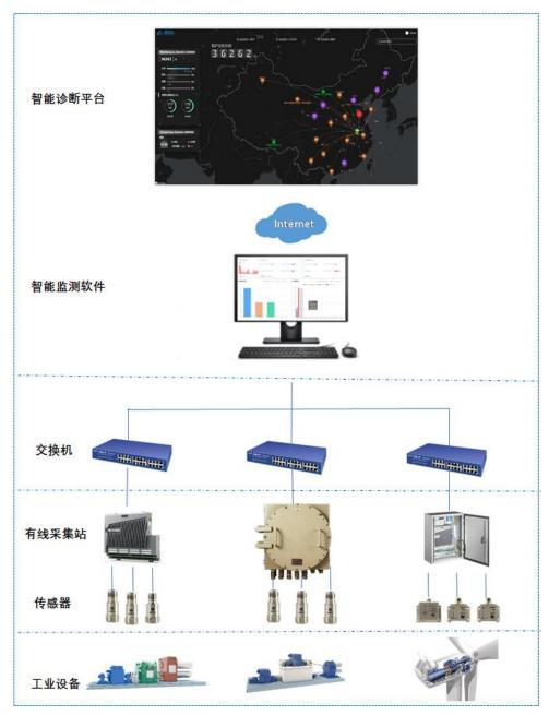
公司的有线系统已构建了"数据全采集、数据智能保存、数据智能报警"体系,数据全采集技术指的是有线采集站与传感器不间断工作,实时采集设备各项运行数据,使得监测无时间盲区;数据智能保存技术指的是采用边缘计算,选取数据质量最高、最能代表设备运行状态的数据进行存储,这使得保存下来的数据均是当前最优数据,避免大量无用数据占据网络带宽和存储空间;数据智能报警技术采用"特征值报警"的综合报警评价体系,较传统技术提升了报警的准确率,降低漏报率和误报率。
