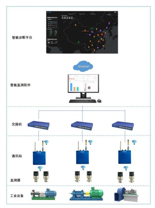
公司无线监测器具备采集频率范围宽、频率分辨率高、数据密度大、边缘智能等特点,能够在设备故障早期发现异常,实现设备故障的有效监测。该系统已在工程应用中实现无线监测器、无线通讯站、系统服务器之间的全无线组网连接,能够避免现场大量的布线工作,维护方便。
