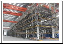
该装置由 9 个分模块组成,总长度 370 米,总重达 1,000 吨。因长度长,整体进行预拼装,对于安装的精度要求较高。
