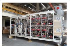
该装置将整个水处理车间进行模块化设计,涵盖水处理工艺全过程,由46个子模块组成,总体尺寸40米\*33米\*13米,总重约900吨。
