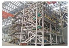
该装置工艺为矿石筛选和精制, 其中筛选、分离、脱水、粉碎、 研磨等流程完整,模块数量及设 备种类繁多,制造精度要求高。 装置主体由 83 个近 20 米长的模 块组成,合计重约 2,500 吨。
