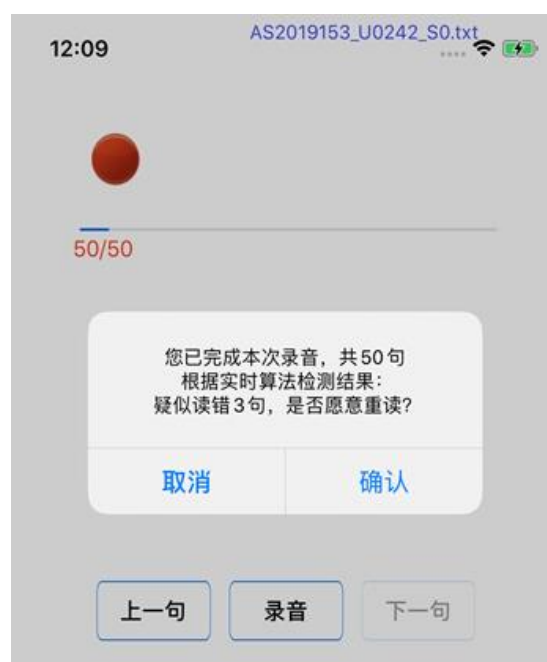
图：语音识别算法在采集环节中的实时质检反馈示例——海天瑞声自主开发的手机端采集软件中，集成了运用语音识别技术校验采集数据情况的功能，并实时向被采集对象提供反馈。
