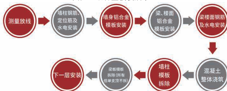
图注：铝合金模板拼装流程
