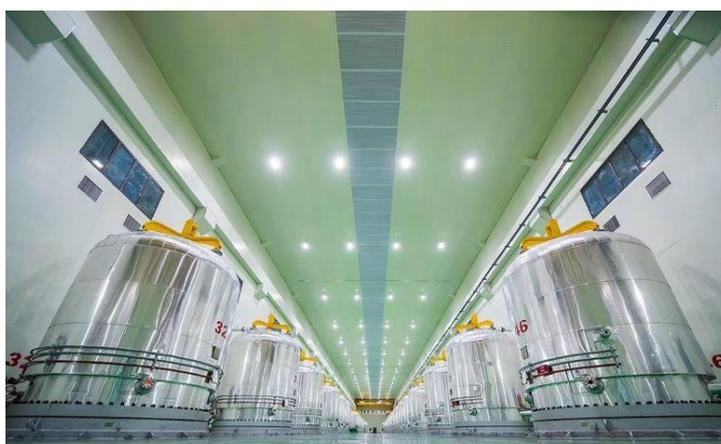
图 4: 多晶硅还原炉
