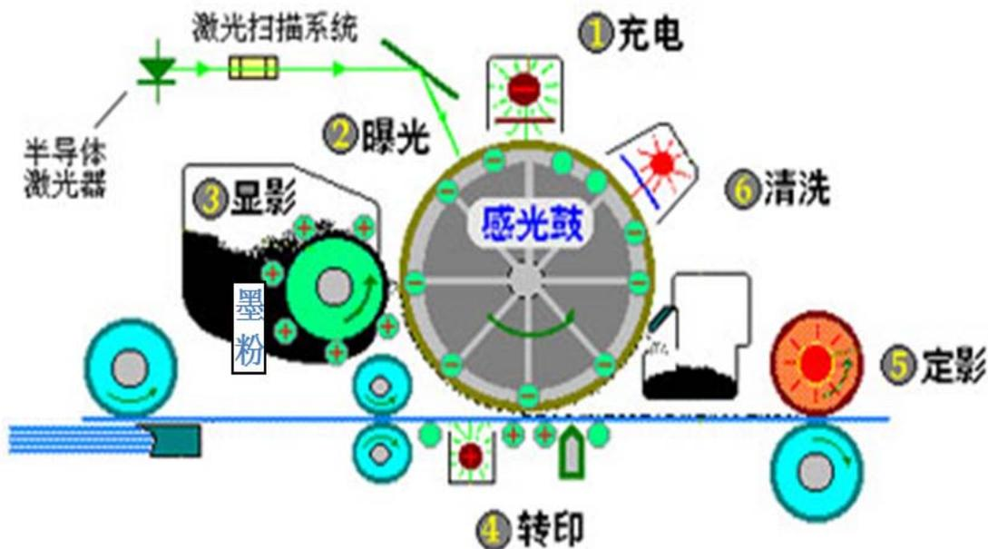
图：有机光导鼓静电成像过程
