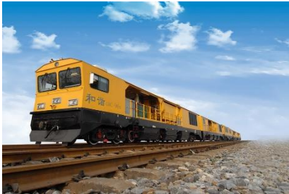
大型养路机械—钢轨打磨列车 GMC-96x
