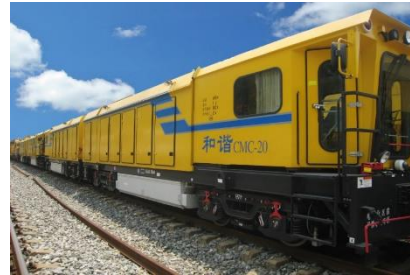
大型养路机械—道岔打磨车 CMC-20
