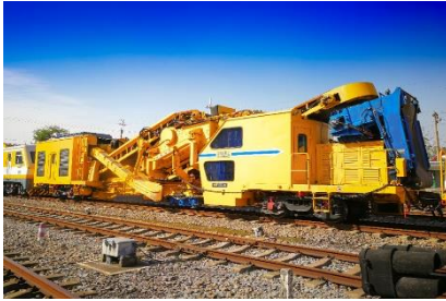
大型养路机械—全断面道砟清筛 QSZ-400
