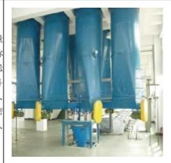
全自动小智能化多本系统是多品种多工位的自动化配料系统,料配料称工位物料配料过程自动进行,只需人工装填原料、取量系统 自动配料 走配好的物料。系统设有投料防错功能,防系统 止原料装填错误。适用于粉状、粒状、片状
