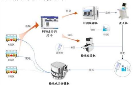
上述流程中,公司产品主要为 PIVAS 排药助手、针剂统排机、盘点机、输液贴签机、输液成品分拣机等。
