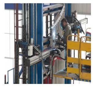
图1HCMT冷焊加工管排
