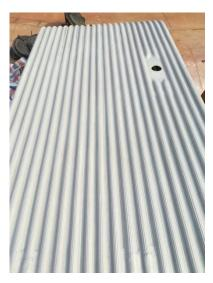
图2 HCMT冷焊加工后的管排
