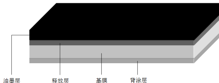
图热转印碳带的组成示意图
