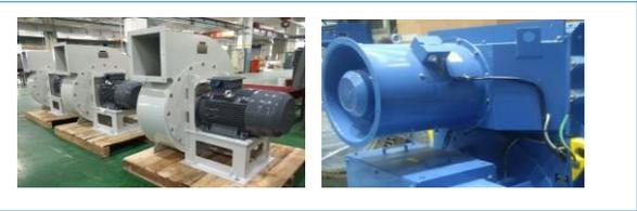
报告期内，公司在风电行业的多款产品实现量产，包含风电电机冷却风机、塔筒轴流风机，其中FDL560-1、FDL500-1、FD400-1、FD315-1等型号产品已量产并通过现场使用。
