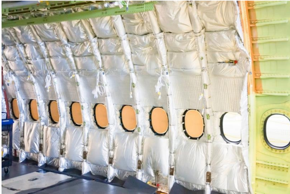
（图： 装配隔音隔热毯的机舱）
