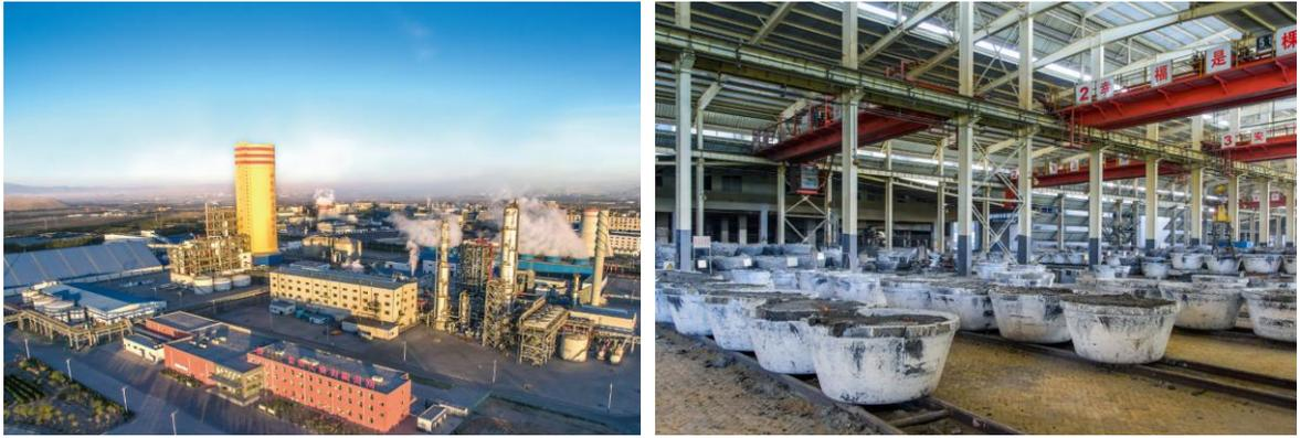
氯碱化工业务同为电冶集团的重要收入来源。氯碱化工业务是指利用石灰石、兰炭和电极糊等原材料，由自备电厂提供电力，生产电石和 PVC 等主要产品以及副产品烧碱。产品主要销向 PVC 生产厂商、塑料制品生产厂商、氧化铝产品生产厂商等。
