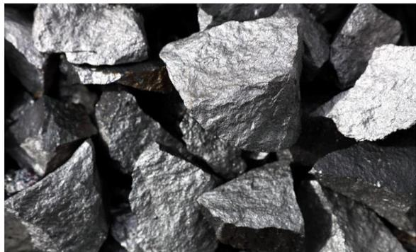
铁合金冶炼业务是电冶集团的重要收入来源。铁合金冶炼业务是指利用硅石、锰矿石、兰炭、球团矿、白云石和电极糊等原材料,由自备电厂提供电力,进行精炼硅铁、高纯硅铁、硅锰合金等铁合金产品的冶炼,产品主要销向钢铁冶炼及金属镁厂商。
