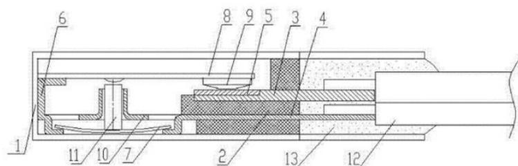
1.壳体；2.环氧树脂1；3.静触点；4.导电片；5.静触点；6.导电支座；7.双金属片；8.弹簧片；
