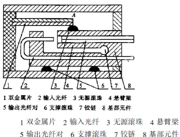
图 3：双金属片光纤温度传感器结构
