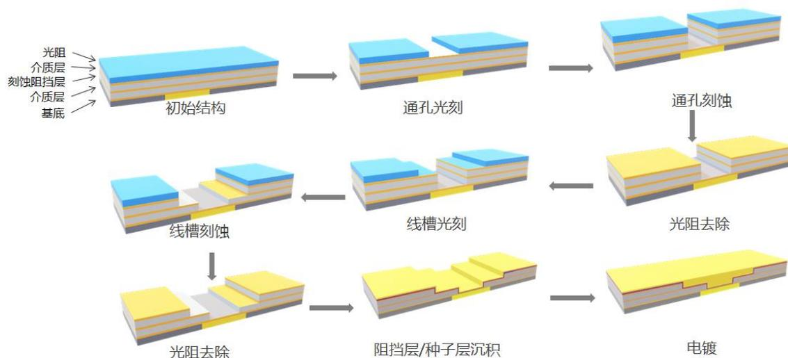
半导体电镀随着晶圆级封装工艺的发展，在三维硅通孔、重布线、凸块工艺中都需要金属化薄膜沉积工艺，使用电镀工艺进行金属铜、镍、锡、银、金等金属的沉积。
