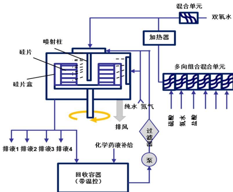
在集成电路制造的先进工艺中，单片清洗已逐步取代槽式清洗成为主流。首先，单片清洗能够在整个制造周期提供更好的工艺控制，改善了单个晶圆和不同晶圆间的均匀性，提高了产品良率；其次，更大尺寸的晶圆和更先进的工艺对于杂质更敏感，槽式清洗出现交叉污染的影响会更大，进而危及整批晶圆的良率，
