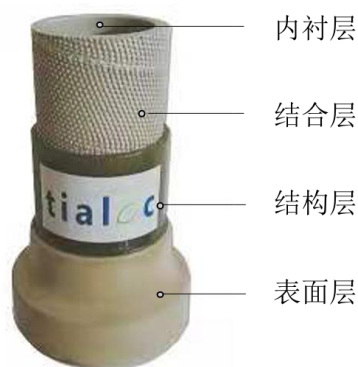
图：Tialoc 复合材料管道示意图
