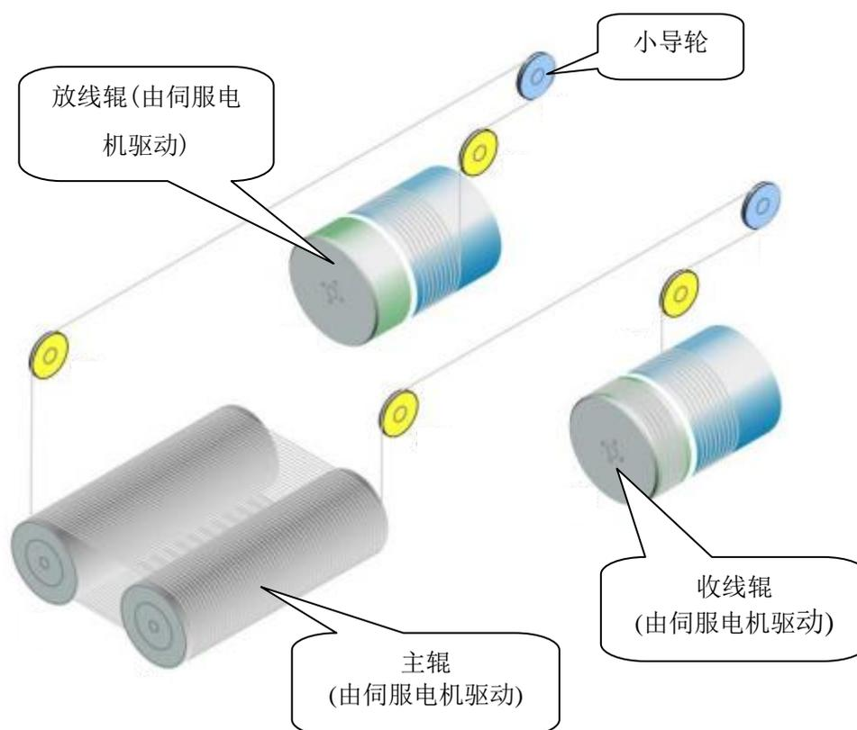
切片机切割硅片的第一步工作是金刚线布线，即：切片机的自动排线系统首先将一根长度 80-200km、直径  $36\mu\text{m}$  及以上的金钢线(人体头发丝直径  $80-90\mu\text{m}$ ) 由放线辊放出进入切割区域，均匀、精密地反复缠绕在切割区域内的 2 根主辊上，主辊上有细密的绕线凹槽，单根金刚线排布在凹槽内，并排布置成约由超过 3,000 根、间距低于  $235\mu\text{m}$  的金钢线线网，然后再被收线轮从切割区域引出。由于金刚线直径和线网密集程度均为微米级，切片机金刚线管理系统需要精准排线，收放线轮、小导轮、主辊均需要同步精准运转，否则容易导致切割过程中金刚线断线，进而可能造成比较严重的硅料损失。
