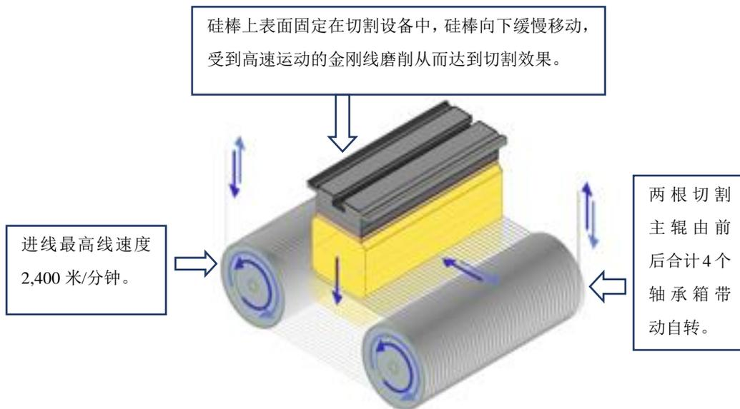
目前应用于切割光伏硅片的金刚线的基线直径在  $40\text{-}57\mu\text{m}$  之间，基线直径比人体头发丝( $80\text{-}90\mu\text{m}$ )还要细；硅片厚度薄至  $170\mu\text{m}$ (A4 纸的厚度约为  $104\mu\text{m}$ )，若手持硅片抖动，硅片即可破碎；另外，硅片有多个严苛的表面质量指标。
