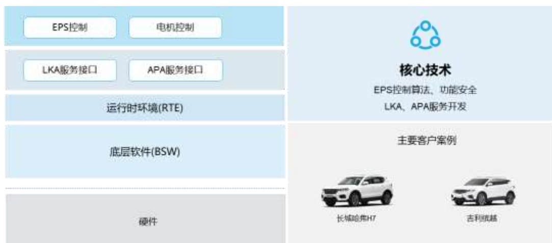
电子助力转向系统（EPS）软件框架及应用
