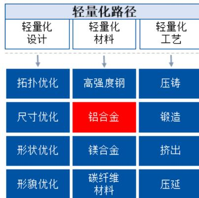
随着我国汽车产业的发展以及汽车轻量化的推进，以铝合金为核心的汽车铝合金精密零部件行业迎来快速发展。第三方研究机构为美国铝金属协会出具的报告预计，汽车铝合金零部件未来的主流成型工艺包括四类，分别为压铸、锻造、挤出和压延，而至 2030 年，在每辆车预计使用的 570 磅铝合金零部件中，有 400 磅是来自于压铸、锻造和挤出三大工艺，占比超过七成。
