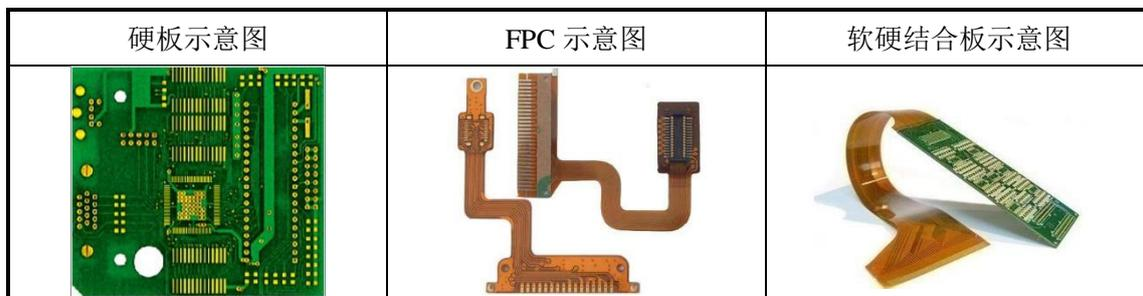
FPC 是以挠性覆铜板为基材制成的一种具有高度可靠性、绝佳可挠性的印刷电路板。作为 PCB 的一种重要类别，FPC 具有配线密度高、重量轻、厚度薄、可折叠弯曲、三维布线等其他类型电路板无法比拟的优势，更符合下游行业中电子产品智能化、便携化发展趋势，被广泛运用于通信、消费类电子、汽车电子、工业、军事、航天等多个领域，其市场需求与下游终端电子产品需求密切相关。
