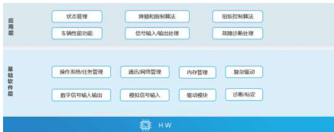
新能源电机控制器软件框架图
