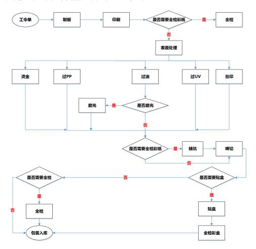
瓦楞纸箱与彩印内盒包装的生产工艺主要节点相同,均是使用模拟或数字的 图像载体将呈色剂/色料(如油墨)转移到承印物上的复制过程,均涉及原稿、 印版、承印物(承印材料)、印刷油墨和印刷机械五大必备要素。
