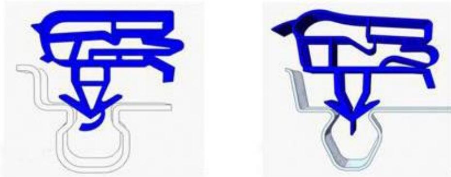
冰箱门密封胶套有数个气囊构成，气囊内部空气存在自然对流热换，气囊结构主要增加门封的传热热阻，因此气囊设计是冰箱门封的核心，对冰箱门封的密封、隔热、节能效果起到关键作用。随着对冰箱节能降耗要求的不断提升，公司不断改进胶套气囊设计，并自主开发门密封胶套挤出模具。由于胶套质软，为保证一次成型提高焊接效率和成品率，公司通过不断研发积累，现已掌握成熟的门密封胶套焊接技术，并研发出自动化四角焊接设备，可实现从一次“单角焊接”到“双角焊接”再到“四角焊接”的工艺升级，焊接效率不断提升。
