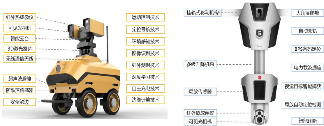
轮式智能巡检机器人核心部件及技术 资料来源：申昊科技
