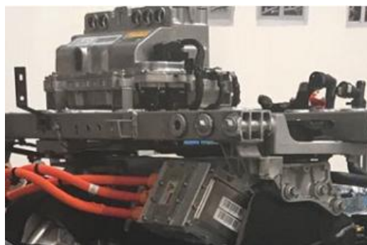
新能源汽车动力总成托架 (图：搭载电机的总成托架)
