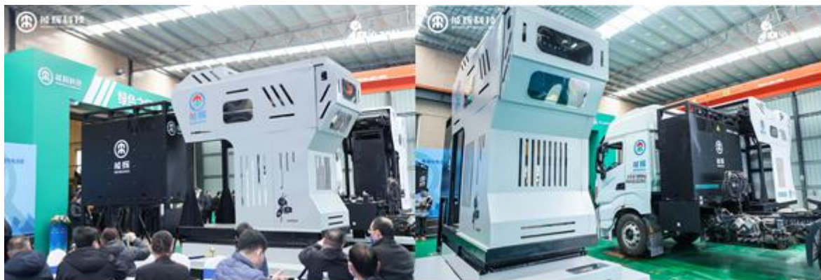
无轨智能“小蚁”重卡换电机器人AGV为重卡换电成功
