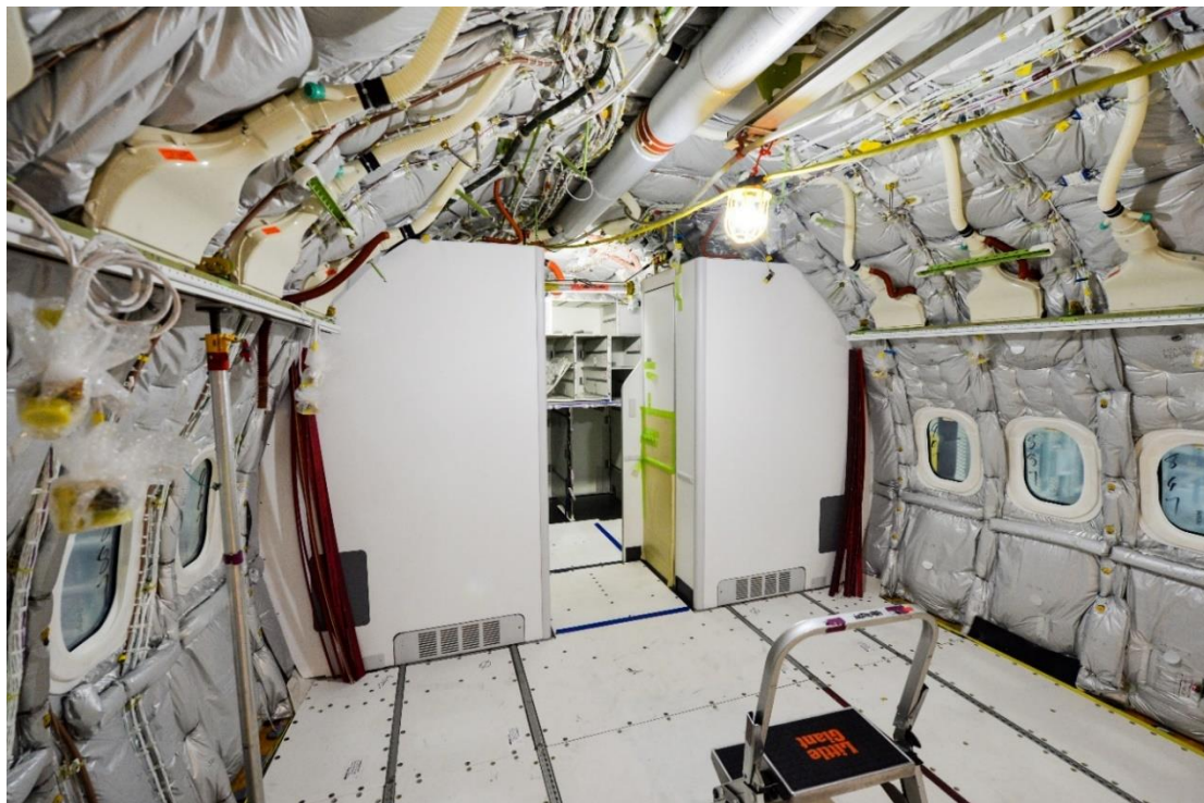
（民航飞机隔音隔热层展示，本图片源于 www.virginaustralia.com ）
