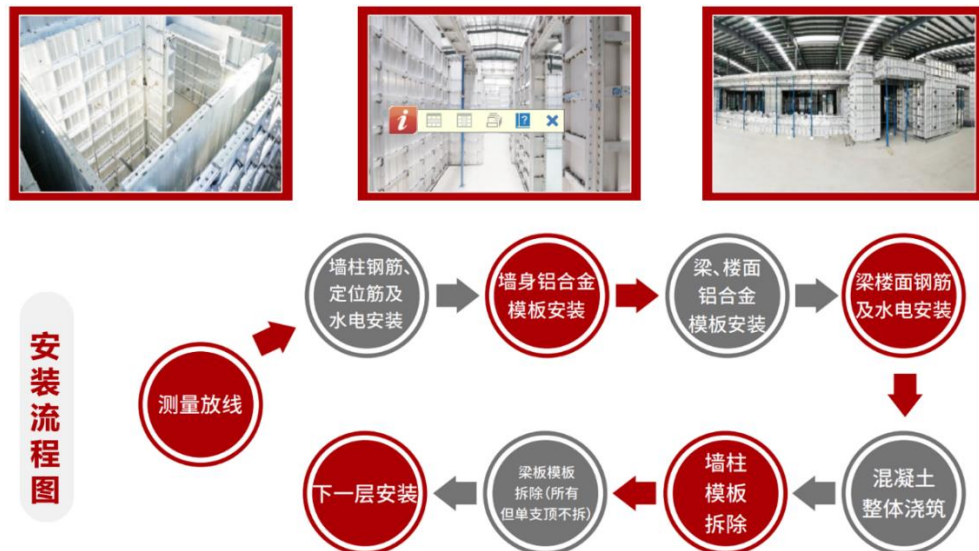
图注 16：铝合金模板示意图及业务流程
