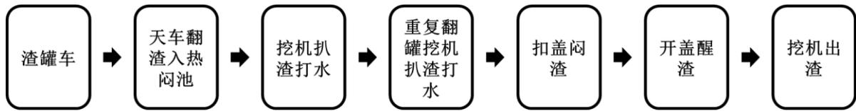
(2) 钢渣热闷、热泼工艺流程
