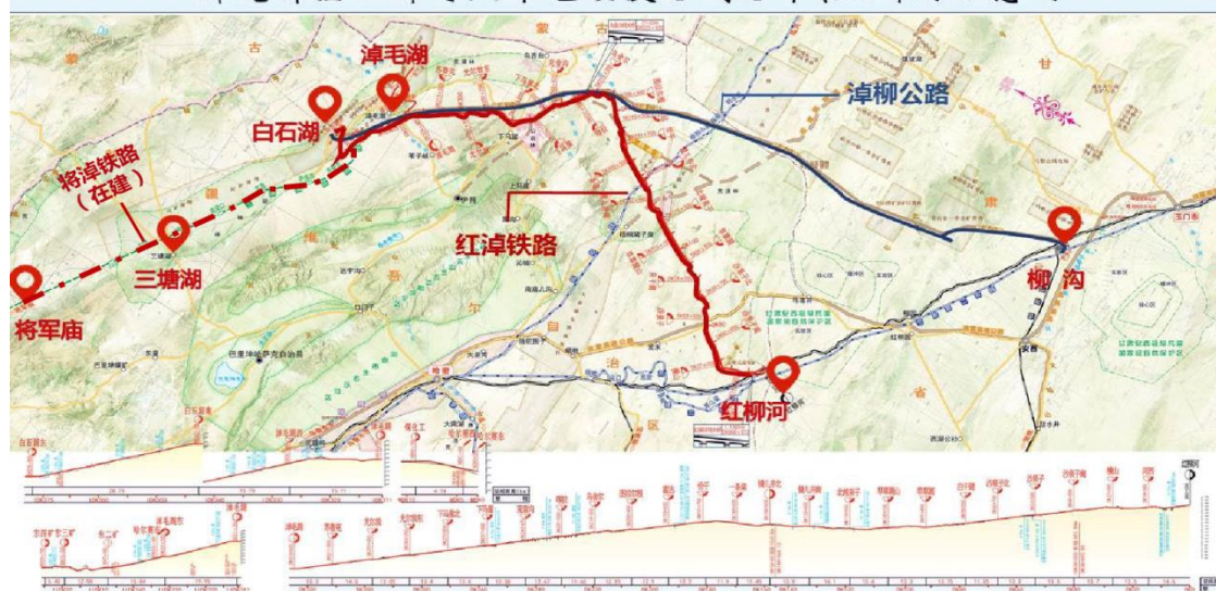
新建新疆红柳河至淖毛湖铁路线路平、纵断面示意图
