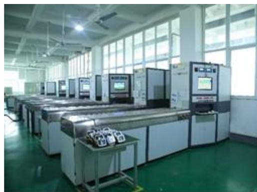
DN25-DN40超声波热量表校验台
