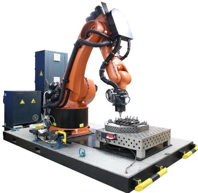
图：公司开发的龙门式及机器人式搅拌摩擦焊装备
