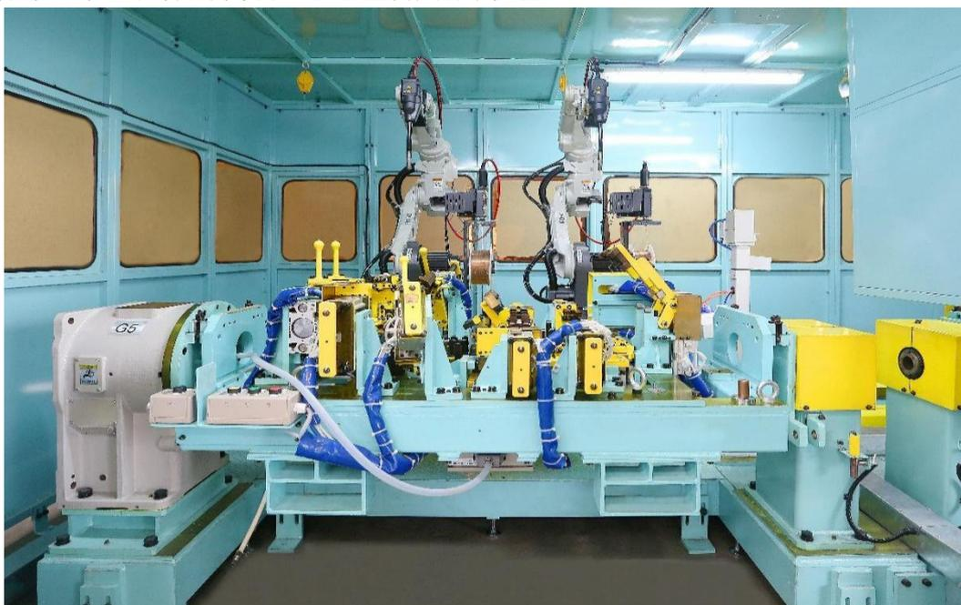
图：公司建造的摩托车焊装生产线
