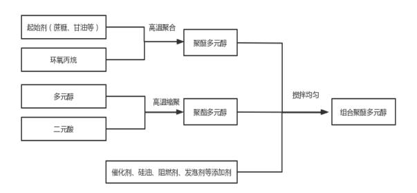
聚醚多元醇为组合聚醚多元醇的主要上游原料,形成泡沫骨架,在配方体系中起到关键作用,是由蔗糖、甘油等起始剂与环氧丙烷高温聚合而成的大分子,通过改变起始剂、环氧丙烷比例或者改变加料方式可以得到不同牌号的聚醚,从而应用于组合聚醚不同配方中。
