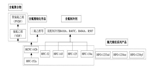
含氟制冷剂生产经过反应、水碱洗、精制等工序制得。主要应用于冰箱、家用空调、汽车空调等制冷领域,还可在聚氨酯行业中用作塑料发泡剂、半导体行业中用作电子清洗剂及精细化工中用作气雾剂等。
