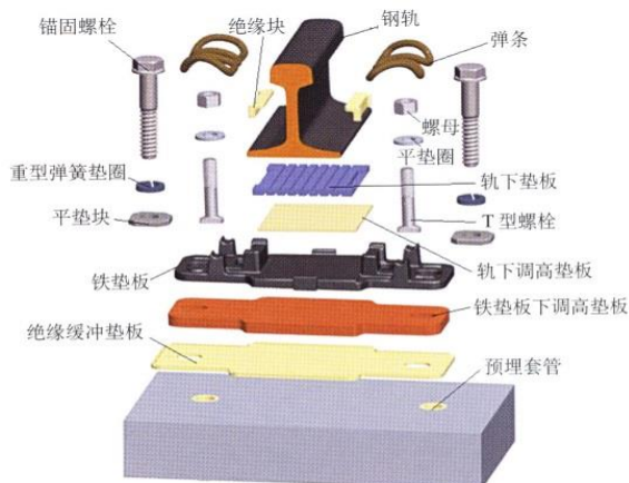
WJ-7型扣件组装零件图
