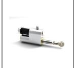
机器人用电液伺服驱动关节由伺服电机、双向2D泵、液压作动器、单向阀、增压式油箱、压力传感器、位置传感器等元件组成,简称为电液作动器(EHA),根据 EHA 是否配置电液伺服阀,又分为:泵控 EHA 和阀控 EHA。具有工作原理简单、体积小、重量轻、功率密度大、噪音低等优点,多应用于人形机器人、高精工程等。
