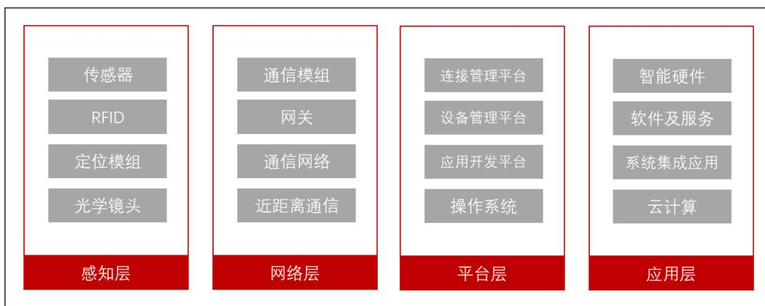
感知层能够感知识别物体或环境状态，并且实现信息的实时采集和捕获。相关信息经由网关等转化为能够识别的信息后传达到网络层，并由网络层对采集的数据进行精准、可靠的传输。平台层提供标准化/模块化的服务，实现数据处理和挖掘、连接管理、设备管理等功能。应用层则主要包括智能硬件、软件及服务、系统集成应用等内容，形成智能化应用的解决方案，从而实现物联网在众多不同领域的运用。
