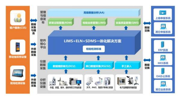
公司检验检测信息管理平台以实验室信息管理系统(LIMS)、电子化原始记录(ELN)、科学数据管理系统(SDMS)一体化解决方案为核心,通过多种方式采集色谱、质谱、天平等专业检测仪器设备数据或外部数据,与内置的检测标准(包括但不限于国家标准、行业标准、企业标准)进行比照分析。经过数据采集、流转、聚类、汇总、分析、报告、评价等过程,公司检验检测信息管理平台可以按用户需求实现研发过程管理、检验业务管理、全面质量管理,并提供外部客户送检与查询服务或与用户其它数据系统进行数据交换,实现高级数据分析(AA)及数据综合利用。
